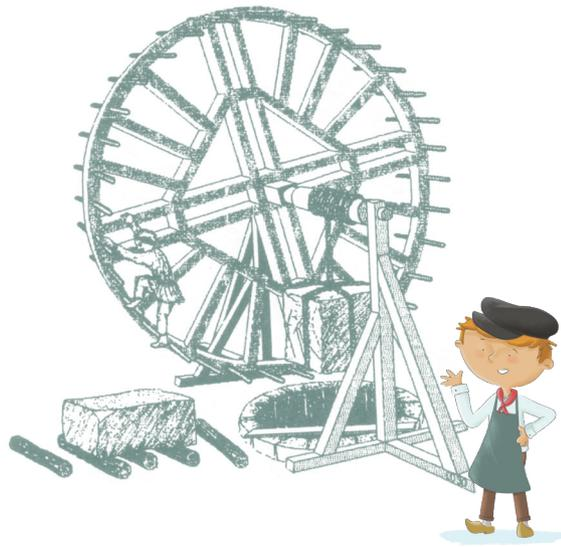
Sais-tu qu'un homme de 80 kg lève un bloc d'une tonne (1000kg) en gravissant 250 mètres d'échelle afin de remonter ce bloc d'une profondeur de .....
